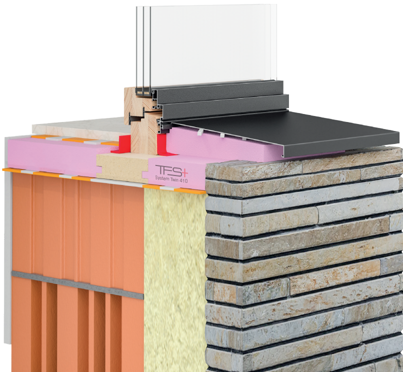
System Twin 410 Dicke 50/40 mm Für zweischaliges Mauerwerk
