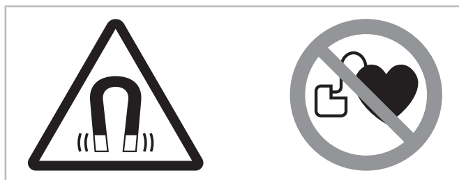
Fig. 21: Panneaux d'avertissement et d'interdiction apposés sur un compresseur avec moteur à aimant permanent
