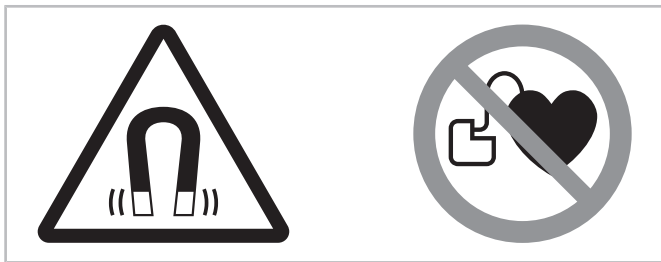
Abb. 21: Warn- und Verbotsschilder auf einem Verdichter mit Permanentmagnetmotor
