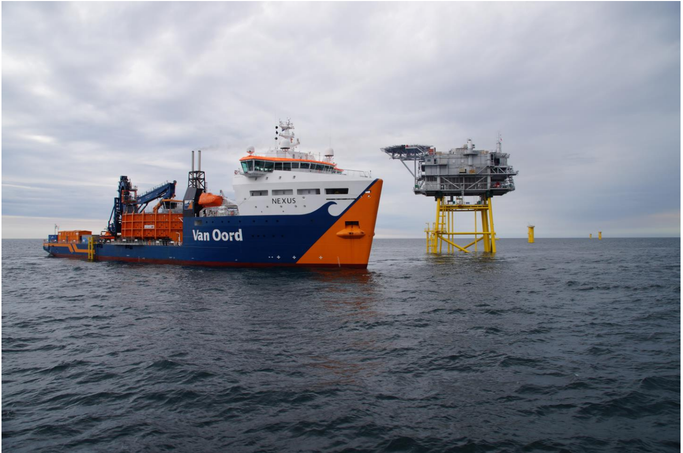
FOTO 2.6-3. KAABLIPAIGALDUSLAEV NEXUS NING MEREL PAIKNEV ALAJAAM (ALLIKAS: VAN OORD)
