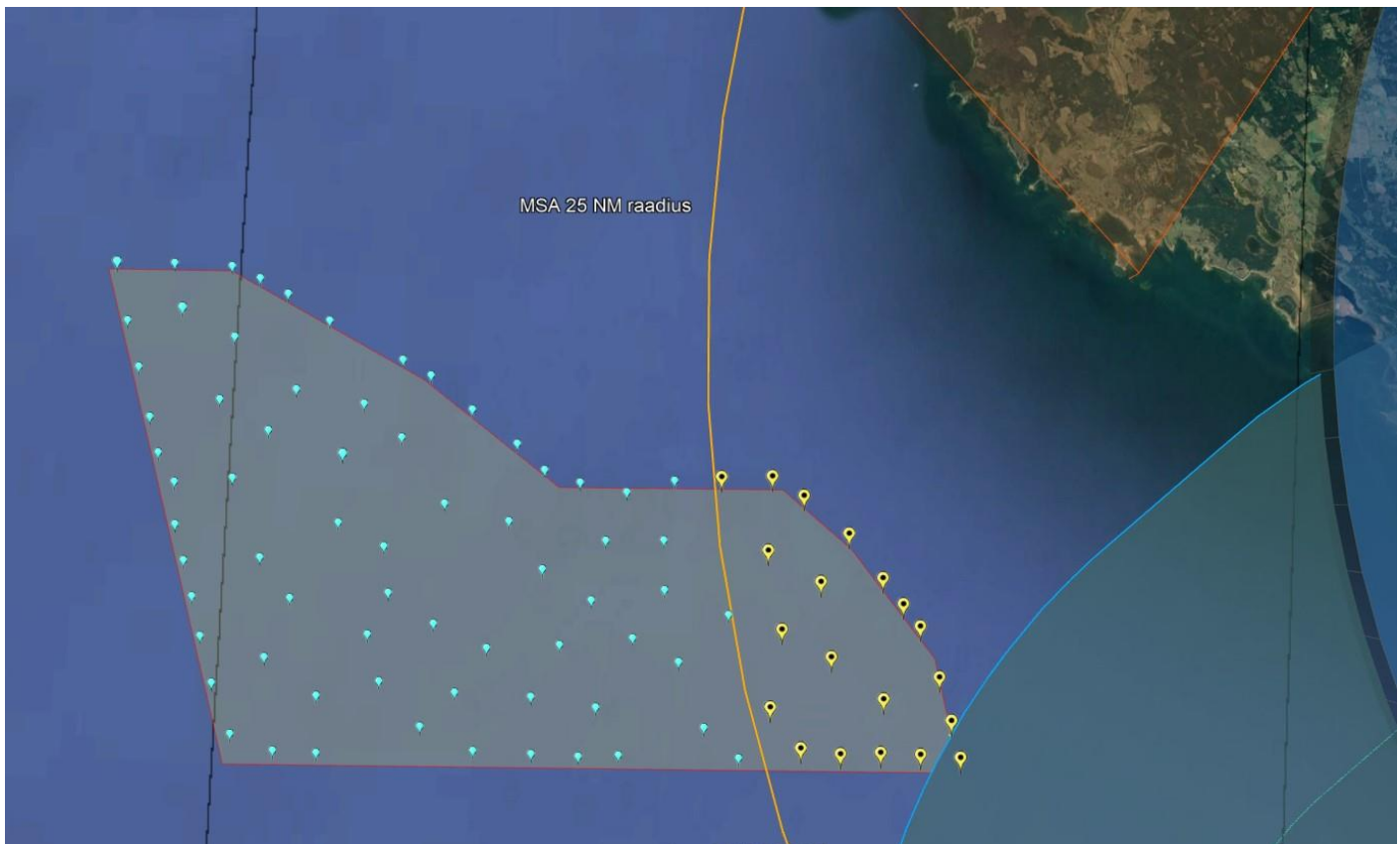
JOONIS 6.2-1. MSA JA PLANEERITUD MERETUULEPARGI KATTUVUS. KOLLASE TÄHISTUSEGA ON MÄRGITUD TUULIKUD, MIS MÕJUTAVAD MSA-D
