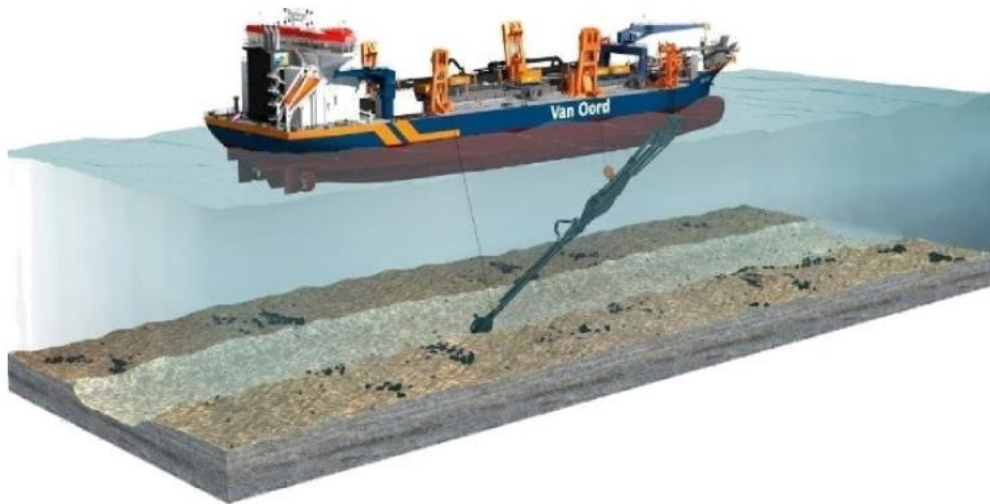
SKEEM 2.6-1. MEREPÕHJA SETETE EEMALDAMINE TSHD ( TRAILING SUCTION HOPPER DREDGERS ) LAEVAGA (ALLIKAS: VAN OORD)
