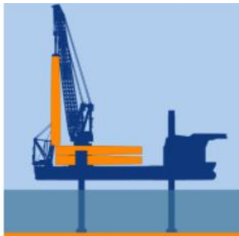
4) Vaivundament on püstiasendis
