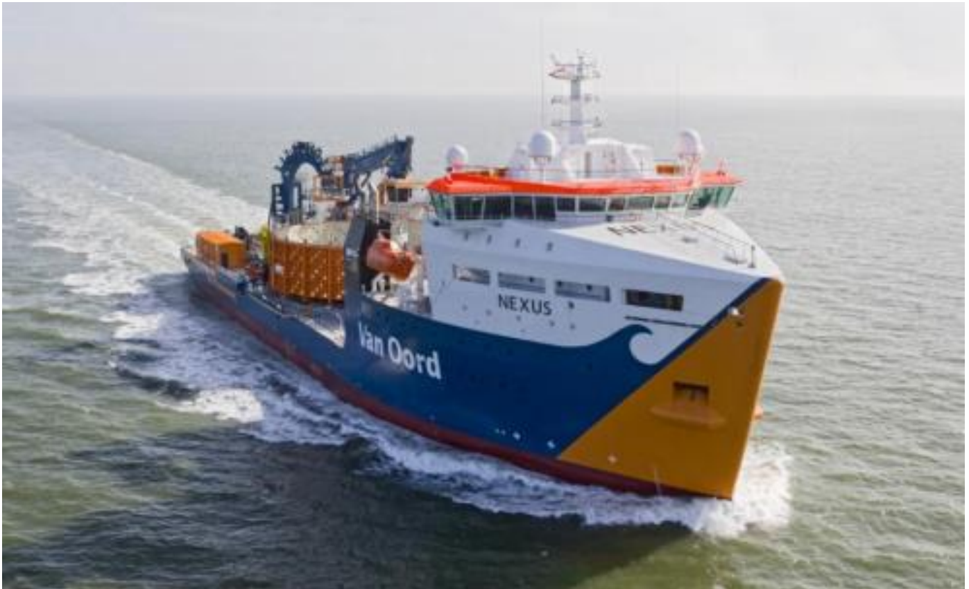
FOTO 2.6-7. KAABLI PAIGALDAMISE LAEV NEXUS (ALLIKAS: VAN OORD)
