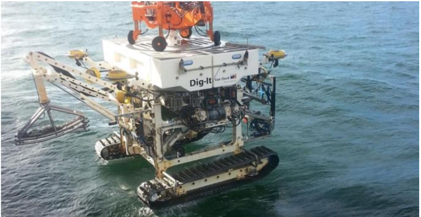
FOTO 2.6-8. KAABLITE PAIGALDAMISE SPETSIAALNE TEHNIKA DIG-IT (ALLIKAS: VAN OORD)
