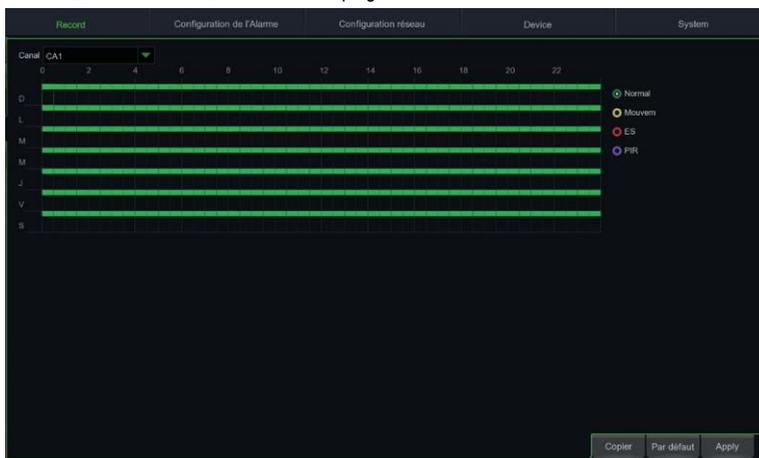
2. Dans le menu « Enregistrement », il est possible de régler le flux à enregistrer : Mainstream ou DualStream (Mainstream + Substream).
