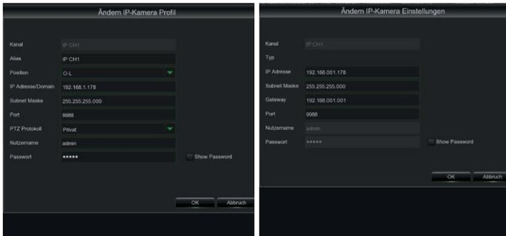
Um die Netzwerkparameter der angeschlossenen Kamera zu ändern (Beispiel: IP-Adresse der Kamera von DHCP auf statisch, Maske, Gateway, Port), die Taste
