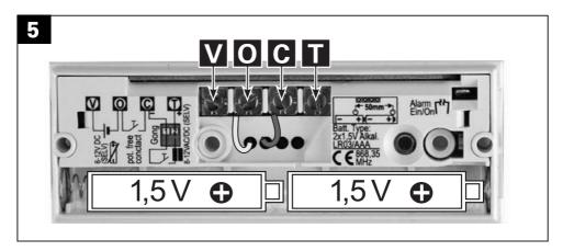
Entfernen Sie die Isolierung der Adern auf ca. 6 mm und schieben Sie sie vorsichtig durch die Dichtungstüllen auf der Rückseite des Funkklingeltasters. Schneiden sie vorher gegebenenfalls die obere Spitze der Dichtungstüllen ab.
