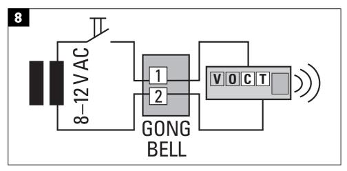
Verwenden Sie die Klemmen 'C' und 'T', um den Funkklingeltaster an eine Klingelanlage mit mechanischem Gong oder Läutewerk (3–12 V AC/DC) anzuschließen. Bei einer Triggerung mit Gleichspannung wird der Minus- pol (-) an 'C' und der Pluspol (+) an 'T' angeschlossen.
