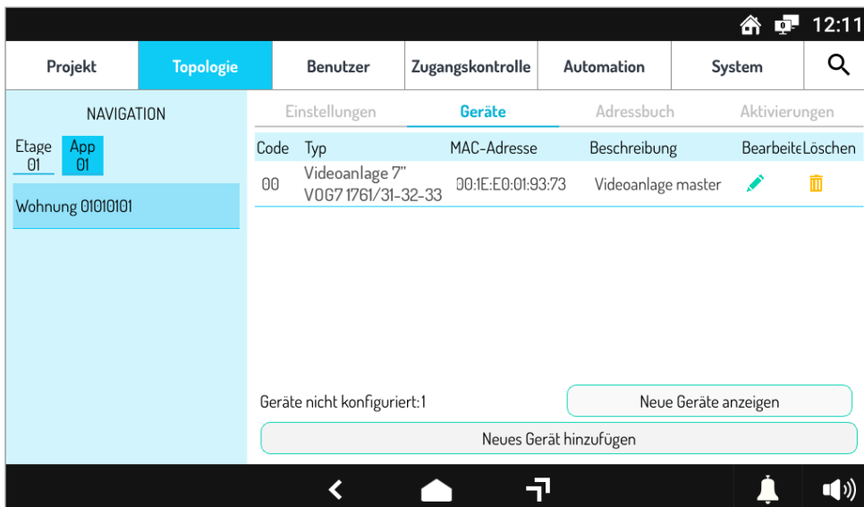
Abbildung 16: Videosprechanlage zur Wohnung hinzugefügt
