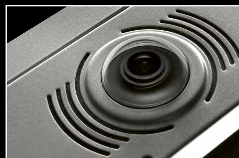
WEITWINKELKAMERA: 113° HORIZONTAL, 92° VERTIKAL
