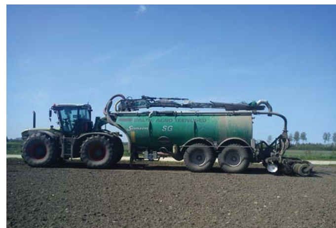
Läga otse mulda viies välditakse eelkõige lämmastiku kadu, säästes seega nii väetisekulu kui ka ümbritsevat keskkonda. Foto: Jaak Reemann
