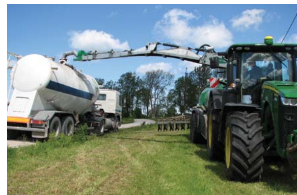
Lämmastiku lendumist ja läga mahavoolamist välditakse ka suletud ümberpumpamissüsteemiga. Sõnnikulaotur ei kasuta selleks mitte voolikut, vaid hüdraulilist hermeetilist imitoru, mis tõmbab tsisternist nelja minutiga koorma endasse, ilma igasuguste kadudeta. Foto: Jaak Reemann
