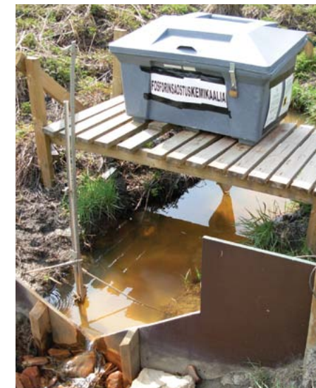
Soomes testitud raud(III)sulfaadi graanulite dosaator suudab madalate vooluhulkade juures setitada 30–80% veekogus lahustunud fosforist. Foto: Kuno Kasak
