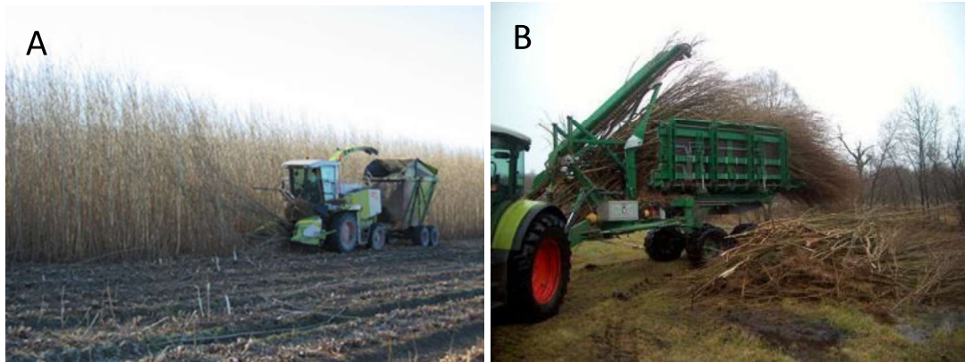
Joonis 5. Pajuistanduste koristamine võib toimuda nii spetsiaalse heederiga varustatud rasketehnika abil (A Rootsis) või rohkem käsitööd nõudva kergema tehnika abil (B Poolas) (Fotod: K. Heinsoo) .
