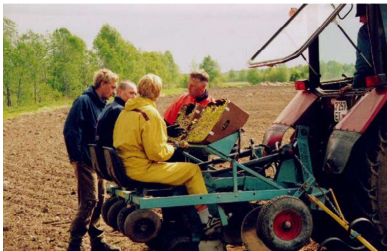
Joonis 3. Pajude istutamine spetsiaalse masinaga Kadrinas, Lääne-Virumaal (Foto: K.Heinsoo).
