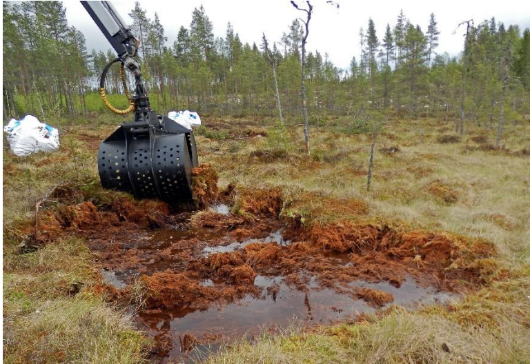
Sambla kogumiseks kasutatav kopp. Foto: Biolan, 2016
