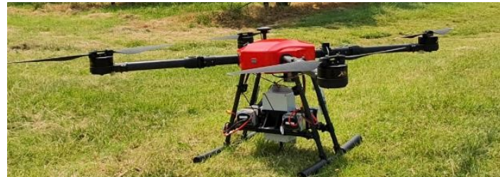
Drone-borne hyperspectral imaging system (acousto-optical monochromator) IFU Institut für Umwelttechnik GmbH
