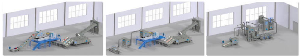
Joonis 6. Näide ANDRITZ Laroche sortimisliinist, millele on võimalik ühildada nii sortimis- kui ka puhastusetapp. Allikas: ANDRITZ tehnoloogiaid tutvustav veebikataloog.
