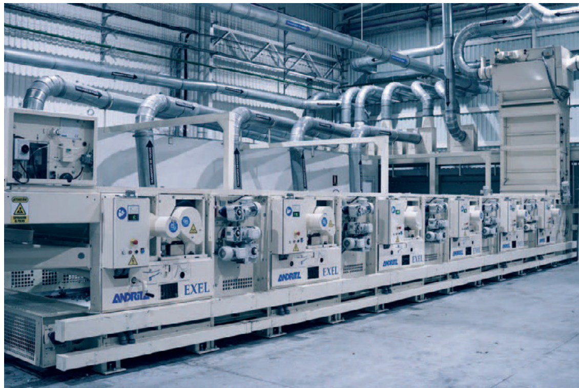
Foto 2. ANDRITZ Laroche Exel kiustamisliin. Allikas: ANDRITZ tekstiiljäätmate ringlussevõtu tehnoloogiaid tutvustav esitlus, 2024.
