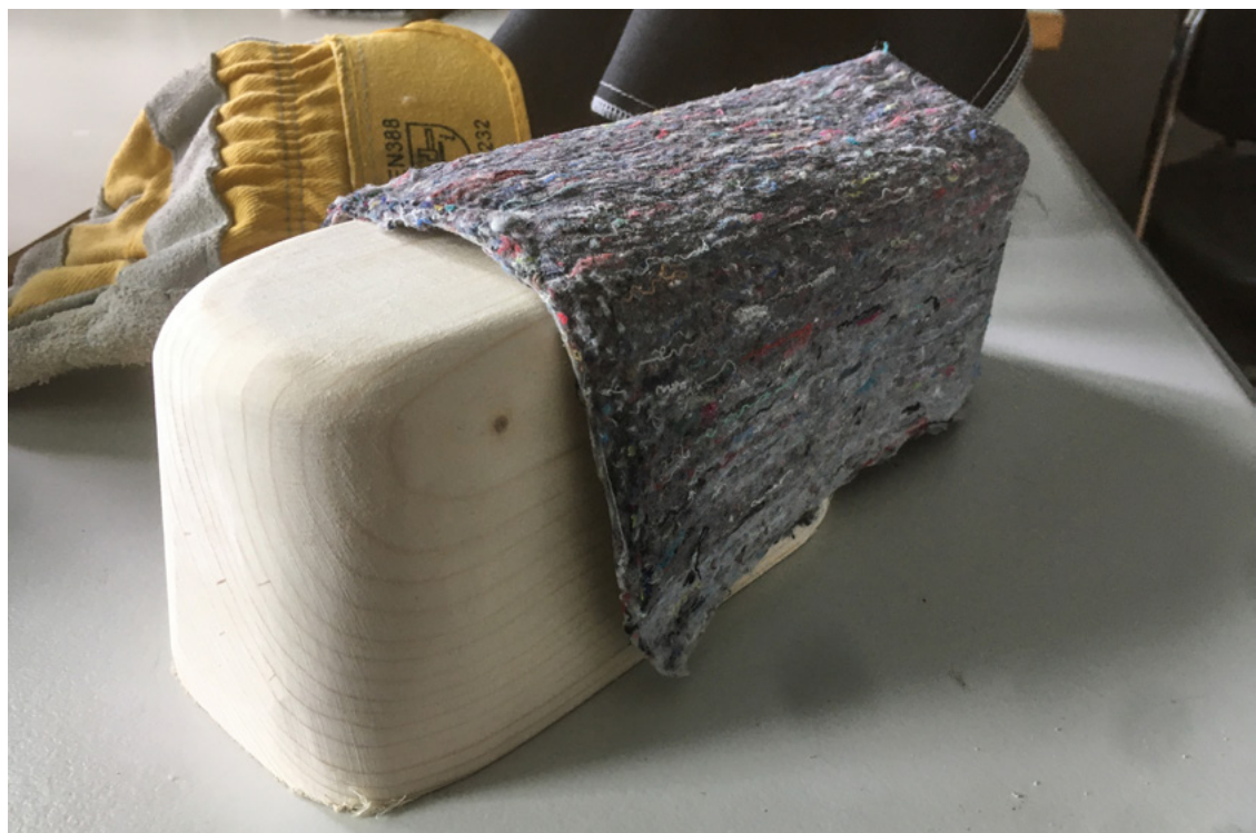
Foto 44. Esimesed vaakumpressimise katsetused väikeses mõõtkavas
