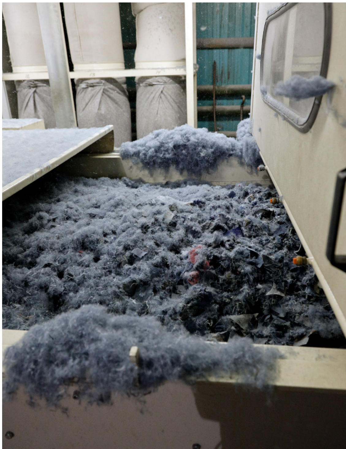
Foto 10. Kiustatud teksad peale esimesest purustamistrumlist väljumist
