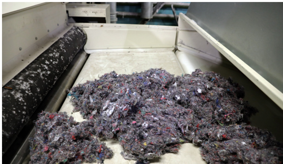
Foto 12. Kiustatud T-särgid peale neljandast trumlist väljumist
