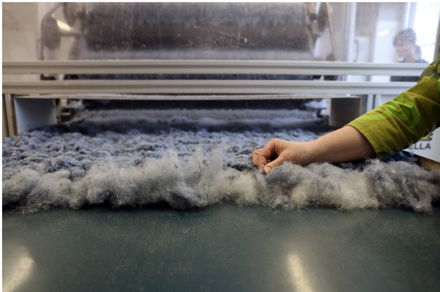
Foto 16. Vill ja ümbertöödeldud teksakiud liikumas kraasiliinil kraasimismasinas
