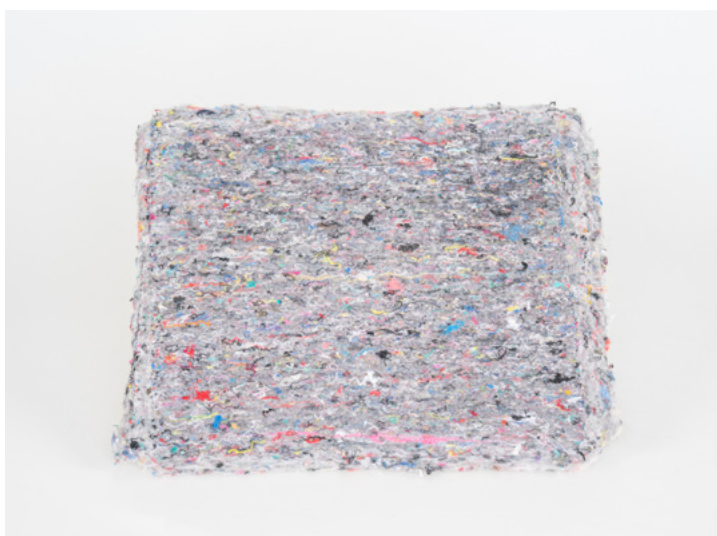
Foto 25. Ümbertööteldud T-särkide tekstiilkiududest ja PLAst koosnev 16-kihiline pressitud lausmaterjal
