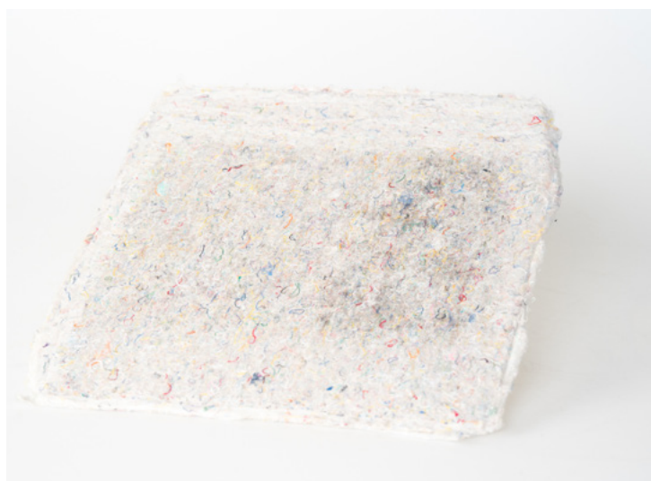
Foto 26. Ümbertööteldud kodutekstiili kiududest ja PLAst koosnev 16-kihiline pressitud lausmaterjal
