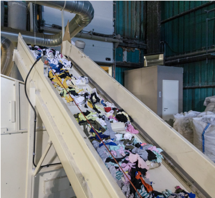
Fotod 6 ja 7. Giljotiinis purustatud tekstiilid liikumas taaskiustamistrumlitesse
