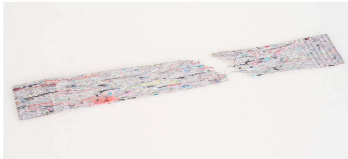
Foto 23. Katkevuskooormuse ja katkepikenemise määramise katsekeha
