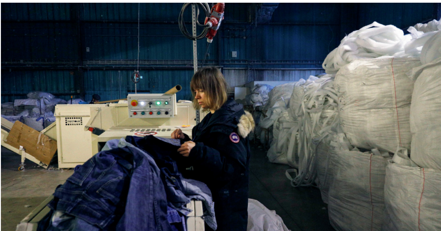
Foto 5. Metallelementidest puhastatud teksad liikumas purustusliinile ASis Paragon Sleep
