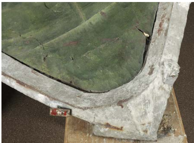
Ill 9. Betoonraami detail enne konserveerimist.
