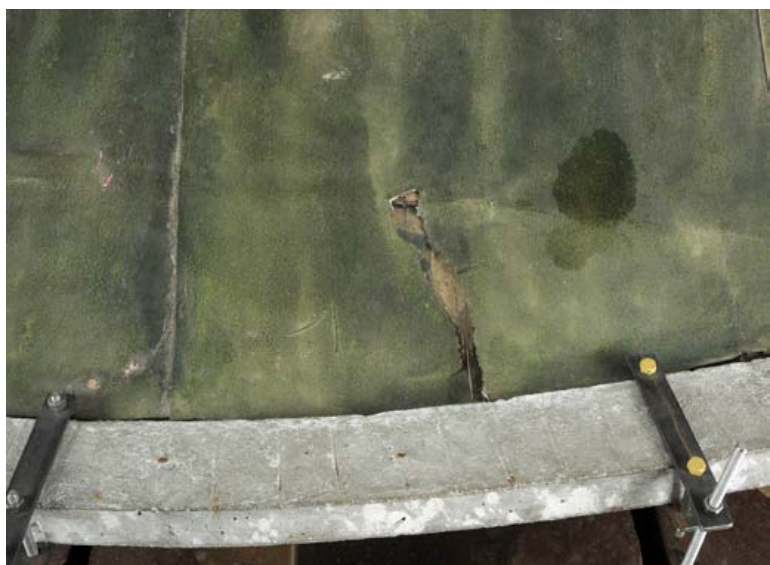
Ill 17–18. Suurimad lõhed ja rebendid paiknesid piki katuse ülaseri. Paber oli määrdunud ja esines üksikuid õliplekke.
