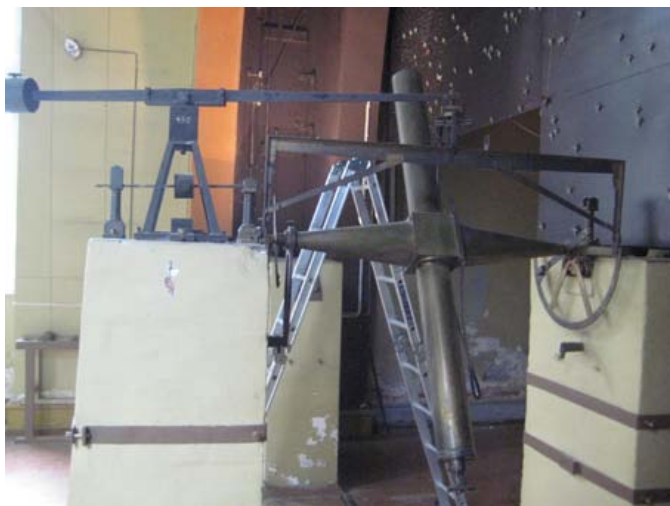
Ill 3. Passaažiriist (komplekt) enne konserveerimist, Dollond, London. tade messingdetaile olid korduvalt üle lakitud ja toneeritud šellaklaki või õilakiga, mis aga oli ajaga värvi muutnud ja seetõttu muutunud kirjuks. Kuukaardid olid määrdunud ja pragunenud. Osa detaile oli irdunud ja viimistluskihis esines rohkesti kadusid. Raamide konstruktsioon oli liimist lahti ja põhjavineerid veekahjustuse mõjul kõmmeldunud.
