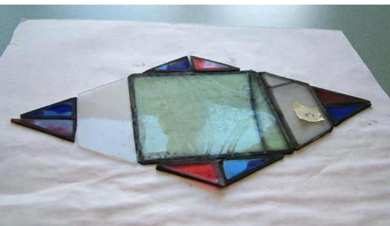
Ill 13. Mateeritud trapetsikujuline asendusklaas vasakul. Klaasid on valmis pliilindiga kokkumonteerimiseks. Foto: Eve Koba.
