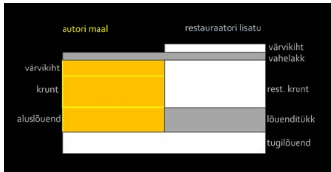
Joonis 1. Maaliterviku taastamise põhimõtteline lõige. Krunt täidab ainult krundi- ja värvikihi struktuurikao. Enne krundi retušeerimist kujutise visuaalse terviku saavutamiseks kantakse maalile vahelakk, mis isoleerib autori ja restauraatori värvid, võimaldades viimaseid vajadusel kergesti eemaldada.
