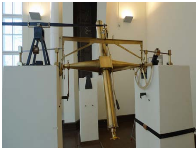
Ill 4. Passaažiriist (komplekt) peale konserveerimist, Dollond, London. suuremad täideti toneeritud vahaga. Kappkelladele valmistati puuduvad iluliistud ja toestati irdunud spooni. Tuhmunud ja mustusega kaetud šellakpoleer puhastati piirituse-vaigutärpentini lahusega, tugevama mustusega kohad atsetooniga. Väiksemad lakikaod toneeriti ja sügavamad praod täideti toneeritud vahaga. Kappkellade šellakpoleeri värskendati šelakpolituuriga. Instrumentide metalldetailide puhul oli suurimaks väljakutseks erinevate detailide, materjalide ja viimistluse rohkus. Instrumentid demonteeriti sõlmede kaupa. Kõik üksikosad fotografeeriti ja omakorda demonteeriti lähtuvalt materjalist. Instrumentide raudosi töödeldi elektrolüüsis 5% seebikivi lahuses. Järgnes terasvilla ja terasharjaga mehaaniline puhastamine, kuivatamine ja poleerimine. Vastavalt detailide toonile konserveeriti neid linaõliga ja kuumutati ahjus kuni detail saavutas algse tooni. Algselt värvitud detailidel taastati pinnakate. Tugevalt oksüdeerunud messingdetailid puhastati triloon-B vesilahuses, kuivatati, poleeriti ja konserveeriti linaõliga. Korrodeerunud polidid ja mutrid puhastati ultrahelivannis ja mehaaniliselt, poleeriti ja oksüdeeriti linaõliga. Astronoomiariistade suuremad messingdetailid olid kaetud instrumendilakiga, mis puhastati 2–5% triammooniumtsitraadi vesilahusega.
