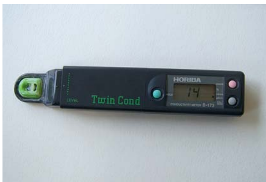
Ill 3. Elektri juhtivuse mõõtur Horiba Twin Cond B-173. Foto: Riin Rohtla.
