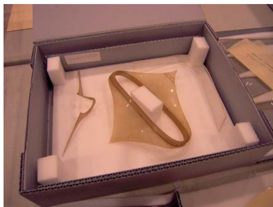
Ill 5. Üksteise külge kleepunud nitrotselluloosist detailid, mida ei saa teineteisest eraldada materjali kahjustamata. Foto: Heige Peets.
