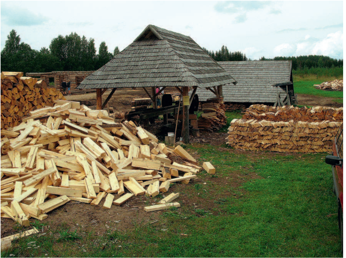
Laastude valmistamine tänapäeval: varikatuse all on 1980. aastail tehtud laastumasin, esiplaanil toormepakud, kõrval valmis laastud. Foto: Joosep Metslang.
