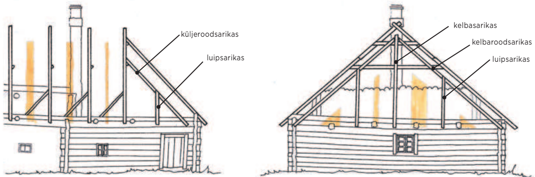
Kahe roodsarikaga rood. Kelbal on vaid üks kelbasarikas ja kaks luipsarikat. Ka küljel on luipsarikas. Skeem: Joosep Metslang.
