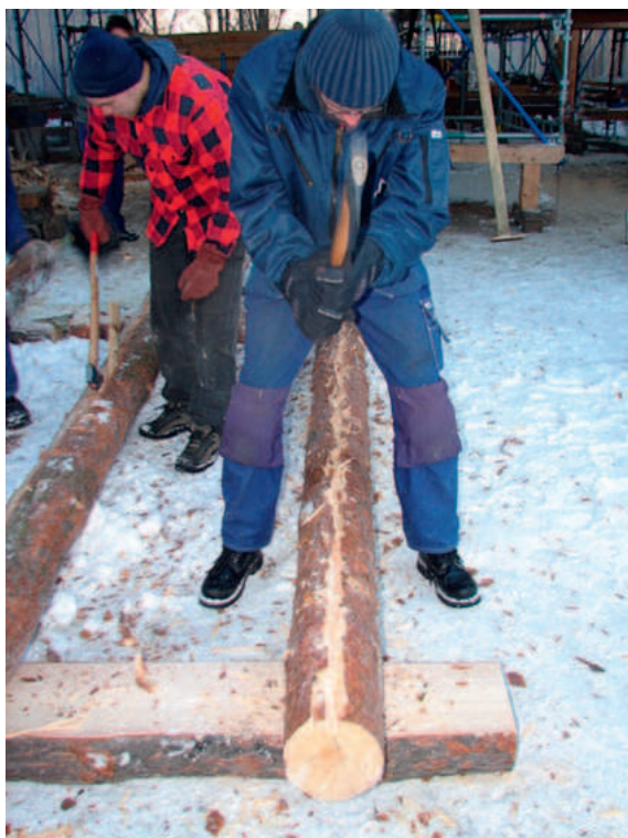
Esmase lõhiku valmistamine kirve, kiilude ja partsuga. Lõhik poolitatakse omakorda kisk- ja pindlauaks. Foto: Viire Kobrusepp.
