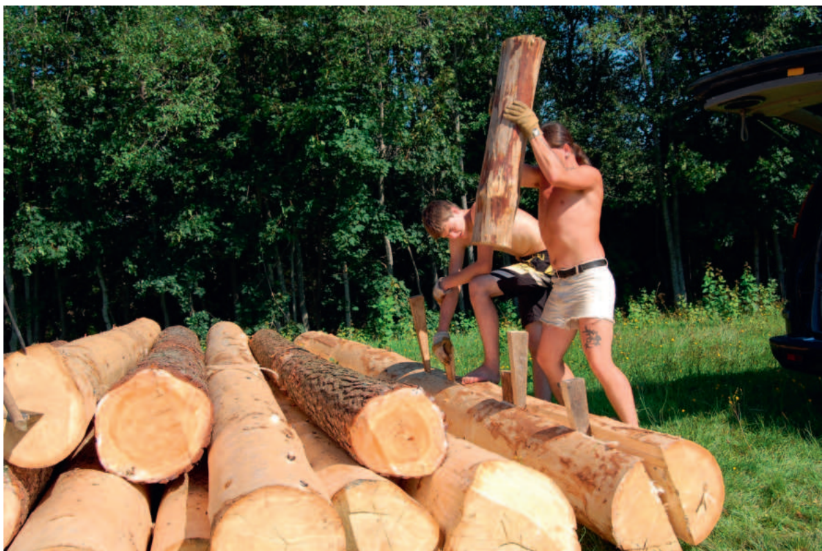
Esmase lõhiku valmistamine kirve, kiilude ja partsuga. Lõhik poolitatakse omakorda kisk- ja pindlauaks. Foto: Viire Kobrusepp.
