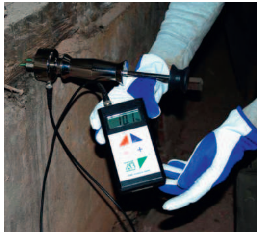
Niiskussisalduse mõõtmine elektritakistuse põhimõttel. Foto: Marko Teder.
