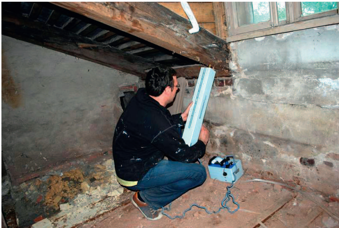
Sarika seisukorra kontroll vastupanu-mikropuuriga. Foto: Marko Teder.
