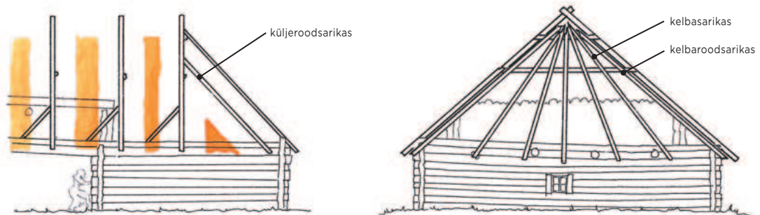
Kahe roodsarikaga rood. Küljeroodsarikas toetub tavasarikapaarile ja kelbaroodsarikas koos kelbasarikatega abilatile. Skeem: Joosep Metslang.
