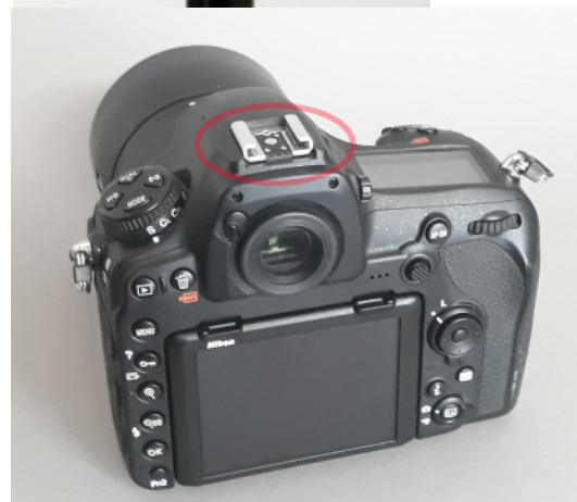
ill. 10 välgusaatja paigutamine kinnitusplaadile
