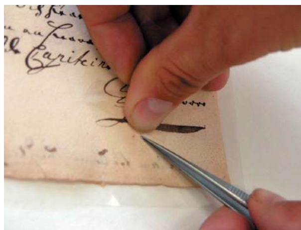
Foto 17. Indikaatorpaberi surumine vastu tindikirja läbi inertse kile, foto: B. Haavasalu.
