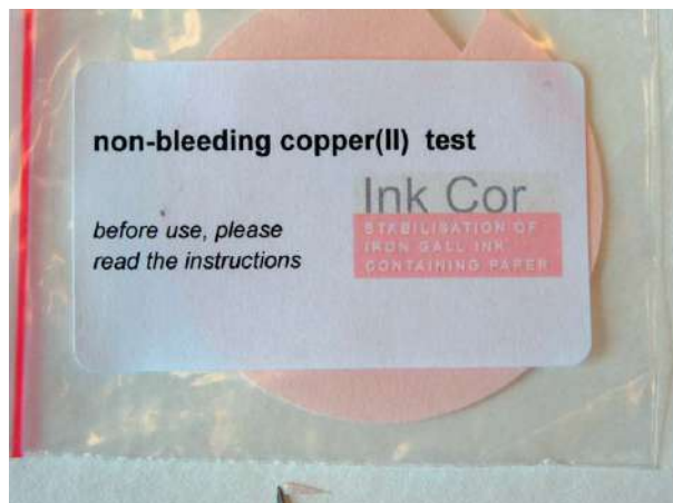
Foto 19. Katseks kasutatud indikaatorpaber ei värvunud siniseks, mis näitab, et antud tint ei sisalda \text{Cu}^{2+} ioone, foto: B. Haavasalu.
