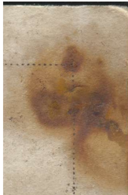
Foto 23 Rooste on tugevalt kahjustanud paberit, kohati on nähtav süvend paberi pinnas. Kahjustusaste 3 – rooste lagundab nii paberit, kui emulsiooni, kahjustus võib niiskes keskkonnas laieneda.
