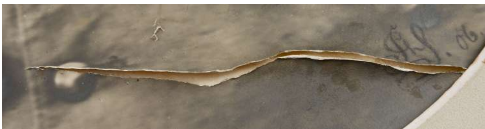
Foto 50 Rebenenud foto servades on emulsioon kohati barüüdikiht lahti, foto taha on kleebitud juhuslik paber. Kahjustusaste 3 – rebend on küll kinnitatud, kuid lahtised servad ja emulsioon võivad vigastuda. Liimitud toetus tuleks asendada arhiivipüsiva materjali vastu.
