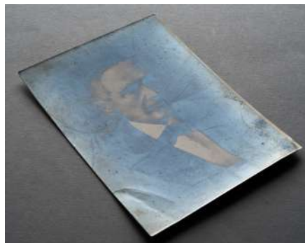
Foto 5 Hõbepeegel katab kogu kujutise tumedaid alasid, kujutis on tuhmunud ning detailid hakkavad kaduma. Kahjustusaste 3 – ebasobivates tingimustes võib kahjustus areneda.
