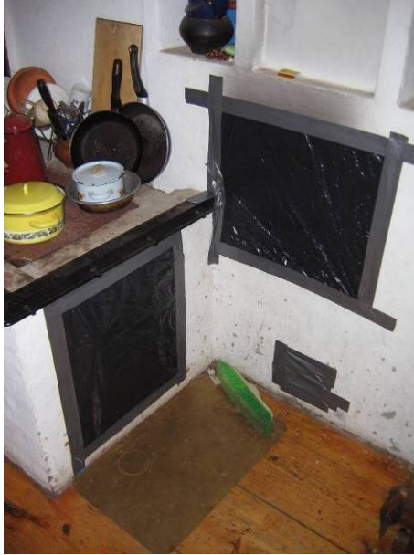
Joonis 7.2 Hoonepiirete õhupidavuse mõõtmise ajaks suleti kõik küttekolded ja ventilatsiooniavad.
