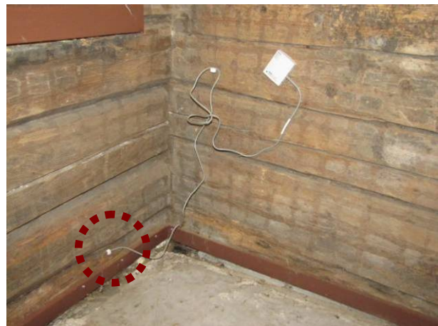
Joonis 3.1 Siseõhu temperatuuri ja suhtelise niiskuse mõõteandur vaheseinal (vasak) ja seinapinnatemperatuuri mõõteandur (paremal). Mõõtekoht on tähistatud punase ringiga.
