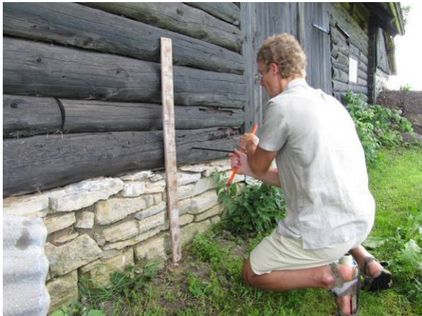
Joonis 2.1 Puiduproovide võtmine seinast (vasakul) ja põrandast (paremal) võimaliku mädanikkahjustuse ja selle ulatuse väljaselgitamiseks.
