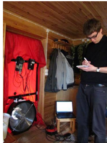
Joonis 7.1 Hoonepiirete õhupidavuse mõõtepõhimõte (vasakul) ja mõõtesead (paremal).
