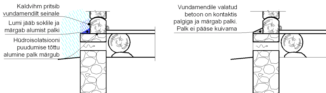
Joonis 2.11 Alumise palgi märgumise peamised põhjused.
