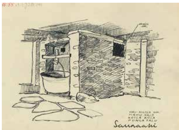
^ Viru-Nigula Koila küla Punga talu saunaahi näeb välja nagu suure reheahju väike vend. Eriline on selle juures ahju küljel olev suur keriseauk, kust kaudu kuum õhk ja leil välja tuli. (Joonis: Eesti Vabaõhumuuseum 1960)
