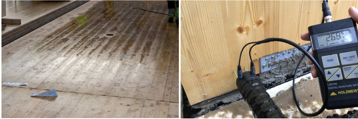
Joonis 4 Puitpaneelide montaaž ilma ilmastikukaitseta on halb lahendus (vasakul ja paremal). Puit on niiskustundlik materjal ja sademetele avatult tõuseb puidu niiskussisaldus üle lubatud piirmäära (paremal). Fotod: Kristo Kalbe.
