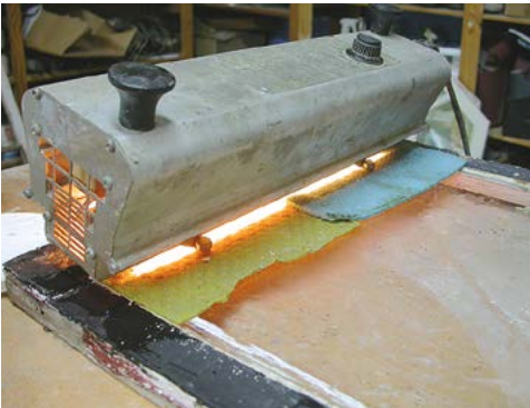
Kitilambi lühilainelised ja fokuseeritud infrapunased kiired sobivad hästi piiritletud piirkonna soojendamiseks.
