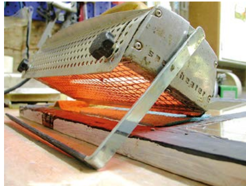
Speedheater'i kesklainelised kiired on suunatud suuremale pinnale. Aparaat sobib ka puidu kuivatamiseks enne värvimist.
