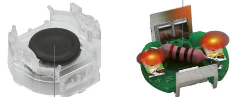
Gummidichtung zum Schutz der Schaltkontakte
