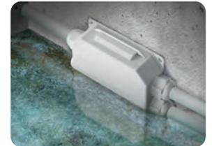
Es ist kein zusätzliches Zubehör erforderlich: die Verteilerdose ist mit einer 3 oder 5-adrigen Klemmleiste und 3 oder 4 Kabelverschraubungen M25 x 1,5 ausgestattet.
