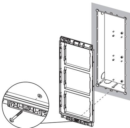
Verwenden Sie die mitgelieferte Schraube, um das Unterteil und den Montagerahmen an der Unterputzdose in der Wand zu befestigen.
