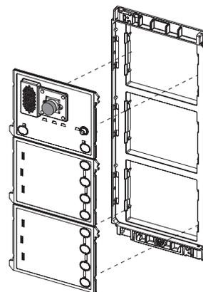
Setzen Sie anschließend die einzelnen Steckmodule in den Montagerahmen ein und verbinden Sie sie mit den beiliegenden Flachkabeln.
