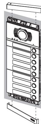
Schließen Sie die Installation ab, indem Sie die Design-Frontblenden und die oberen und unteren Abschlussblenden einsetzen.
