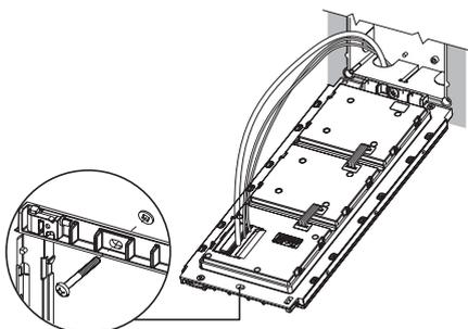
Verbinden Sie die beiden Adern der 2Voice-Busleitung und des Türöffners mit dem Modul und befestigen Sie alles mit der anderen Schraube am Oberteil des Montagerahmens.
