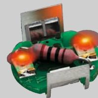
LED-Modul für direkten Anschluss an 8 – 12 V AC
