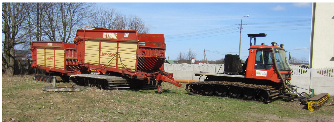
Joonis 20. Biebrza madalsooniitudel kasutatud roomiktraktor ja -käru.
