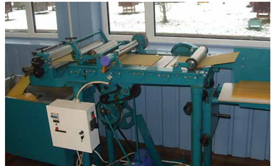
Gravüürvaltsimise masin koos kärjepõhja formaadi lõikusega
