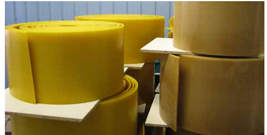
Vahalindid, erinevate partiide vahast. Tumedamast lindist selitatakse jääkained veel kord välja
