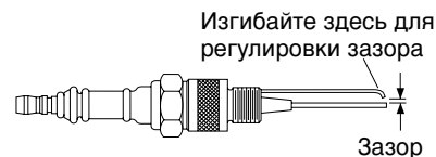
Рис. 15. Регулировка зазора свечи зажигания, нагреватели мощностью 20, 29 и 44 кВт
