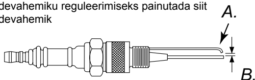
Joonis 15. Süüteküünla sädevahemik, mudelid võimsusega 20 kW, 29 kW, 44 kW.
