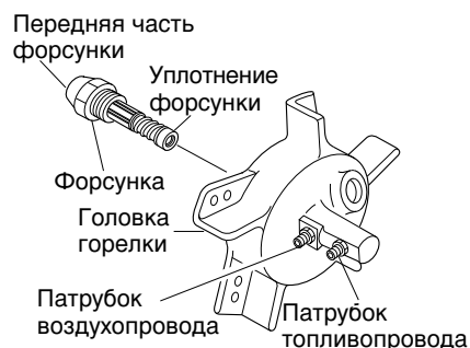
Рис. 24. Снятие форсунки, нагреватели мощностью 20, 29 и 44 кВт
