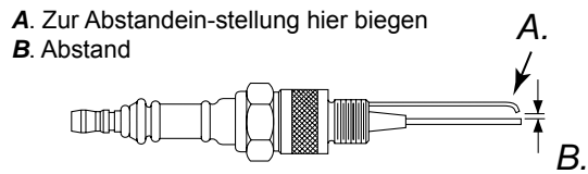
Abbildung 15 – Elektrodenabstand 20, 29, 44 kW Modelle.
