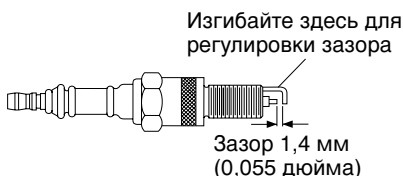
Рис. 12. Регулировка зазора свечи зажигания, нагреватель мощностью 10 кВт
