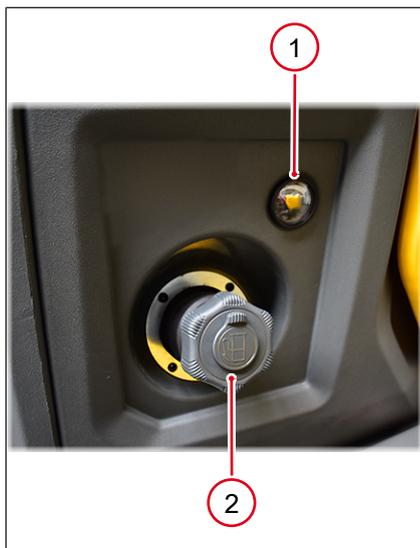
1. Проверить уровень топлива по топливному индикатору **1**.
