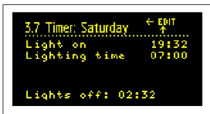
Другой пример настройки таймера. Свет загорается в субботу в 19:32 и горит в течение 7 часов. Свет гаснет в воскресенье в 02:32 утра.
