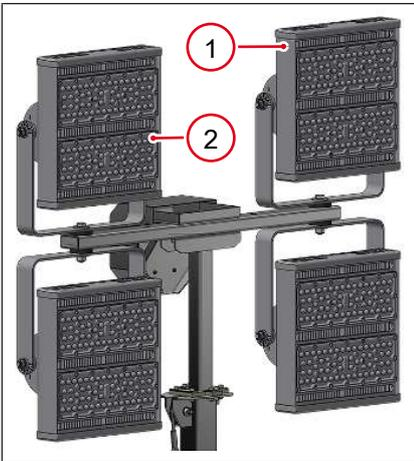
2. Закрепить световые элементы 1 и 2 в верхней части поперечной балки, над внешними световыми элементами.
