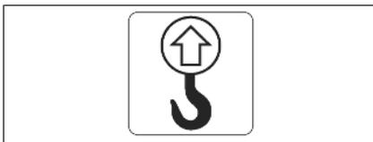
Поднимайте машину только за центральную подвеску при помощи проверенного подъемника и грузозахватных приспособлений (грузового крюка с защитой).
