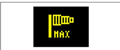
Если датчик ветра обнаруживает опасный порыв ветра, мачта автоматически опускается и на дисплее отображается символ сильного ветра.
