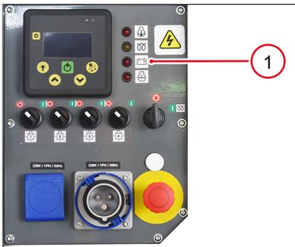
1. Выполнить визуальную проверку контрольных ламп 1. Контрольная лампа горит при низком напряжении аккумулятора.
