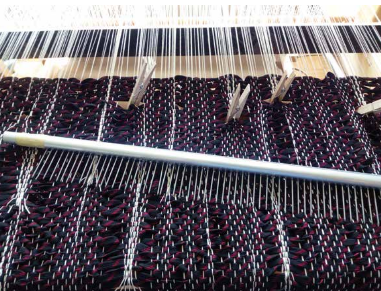
Vaiba Sadu kudusin ilma soata, lõimeetriipe tekitasin kangasse aegajalt lõiegrupe pesulõksudega ohjeldades. Koelõnga lõin kinni alumiiniumtorust ja naeltest muterdatud kammiga. KP
