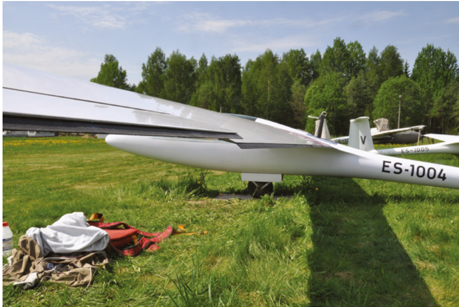
Joonis (Figure) 1. Purilennukile Jantar Standard 3 kinnitatud miniklapid
