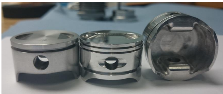
Joonis 1. Vasakul originaalkolb, keskel ja paremal mootorile valmistatud uued kolvid.
