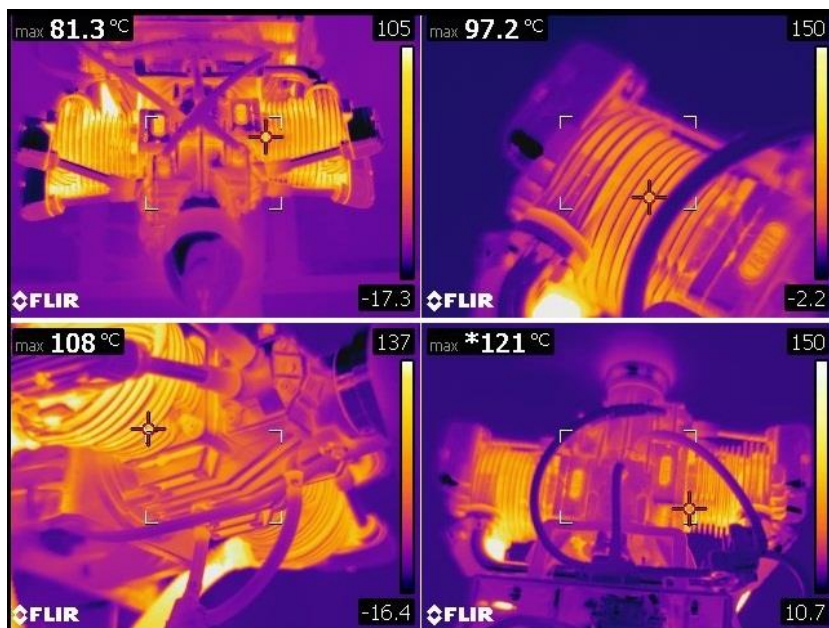
Joonis 2. Infrapunakaamera pildid mootori testimise käigus.
