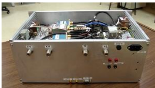
Joonis 1. Eelselektormoodul eest- ja tagantvaates
