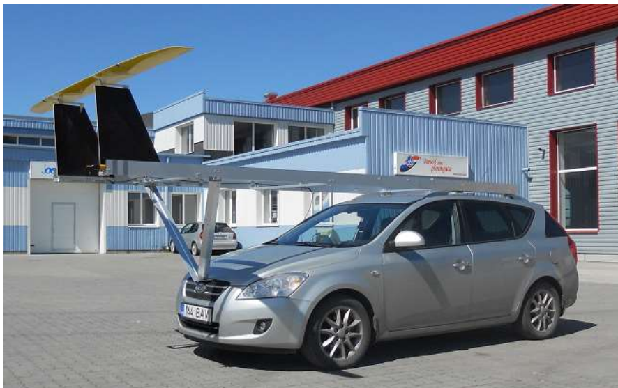
Joonis 2. UAV tiib projekteeritud testseadme küljes
