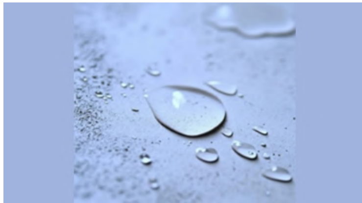
Vesi immitseb kunstimuuseumi hüdrofoobseks töödeldud põrandale mikroskoopilistest avadest ning pindpinevus muudab veepiisad pärliteks, mis liiguvad gravitatsiooni ja isegi kerge tuule mõjul peaaegu nähtamatute õrnade kumeruste ja kallakutega pinnal
