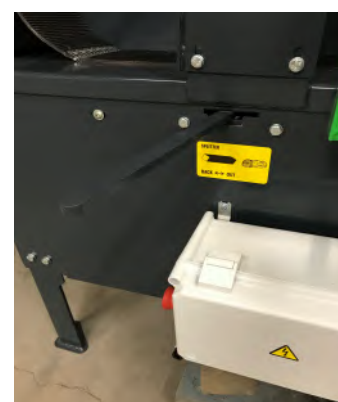
Steuerhebel zum Holzspalten: Vorwärts / Rückwärts
