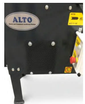
Alle ALTO KSK-62 Modelle haben einen Ölkühler
