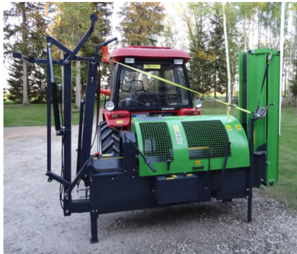
Dreipunkt-Schlepperanbau, mit Antrieb über Zapfwelle, Elektromotor oder kombiniert.
