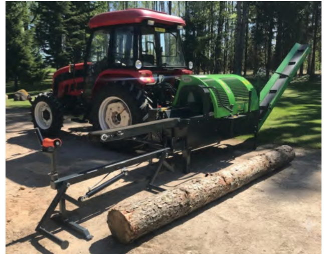
Hydraulisches Einzugsband mit Stammheber, optional.
