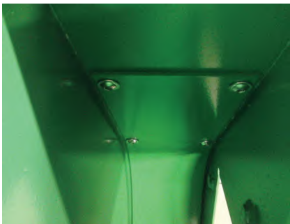
Vahetatav vooder korpuses mis on valmistatud HARDOX terasest.
