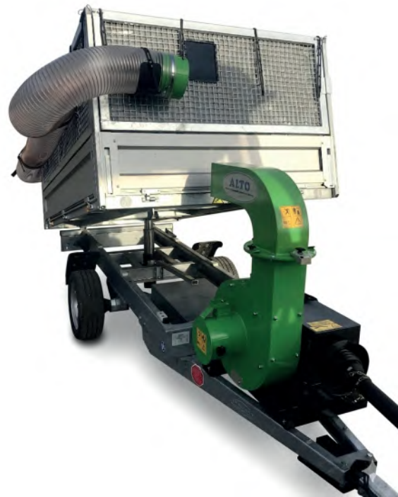
Werkzeuglose Wartung: Schnelldkupplungen an allen Schläuchen und einfach abnehmbarer Auswurfkanal
