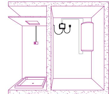
La centralita termostática electrónica de este producto se puede instalar a 5 o 10 metros de distancia del espacio de ducha, lo que ofrece la posibilidad de colocarlo en cualquier parte de la vivienda, como terrazas, trasteros o lavaderos, utilizando el falso techo, interior de muebles, huecos de la bañera...
