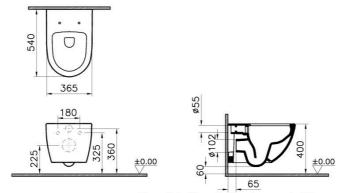
\*Duvar kalınlığına göre ilave boru gerekebilir. \*Additional pipe may be required due to wall thickness \*Ein zusätzliches Ablaufrohr ist je nach Wandstärke erforderlich
