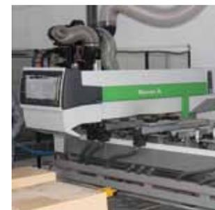
Сверление и фрезеровка технологических отверстий происходит на сверлильных центрах «Biesse Skipper», «Biesse Rover», «Biesse Techno FDT» (Италия).
