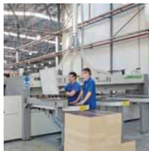
Форматная обработка плит – распиловочные станции «Selco WNT 730» производства «Biesse» (Италия) и «Holzma» (Германия).
