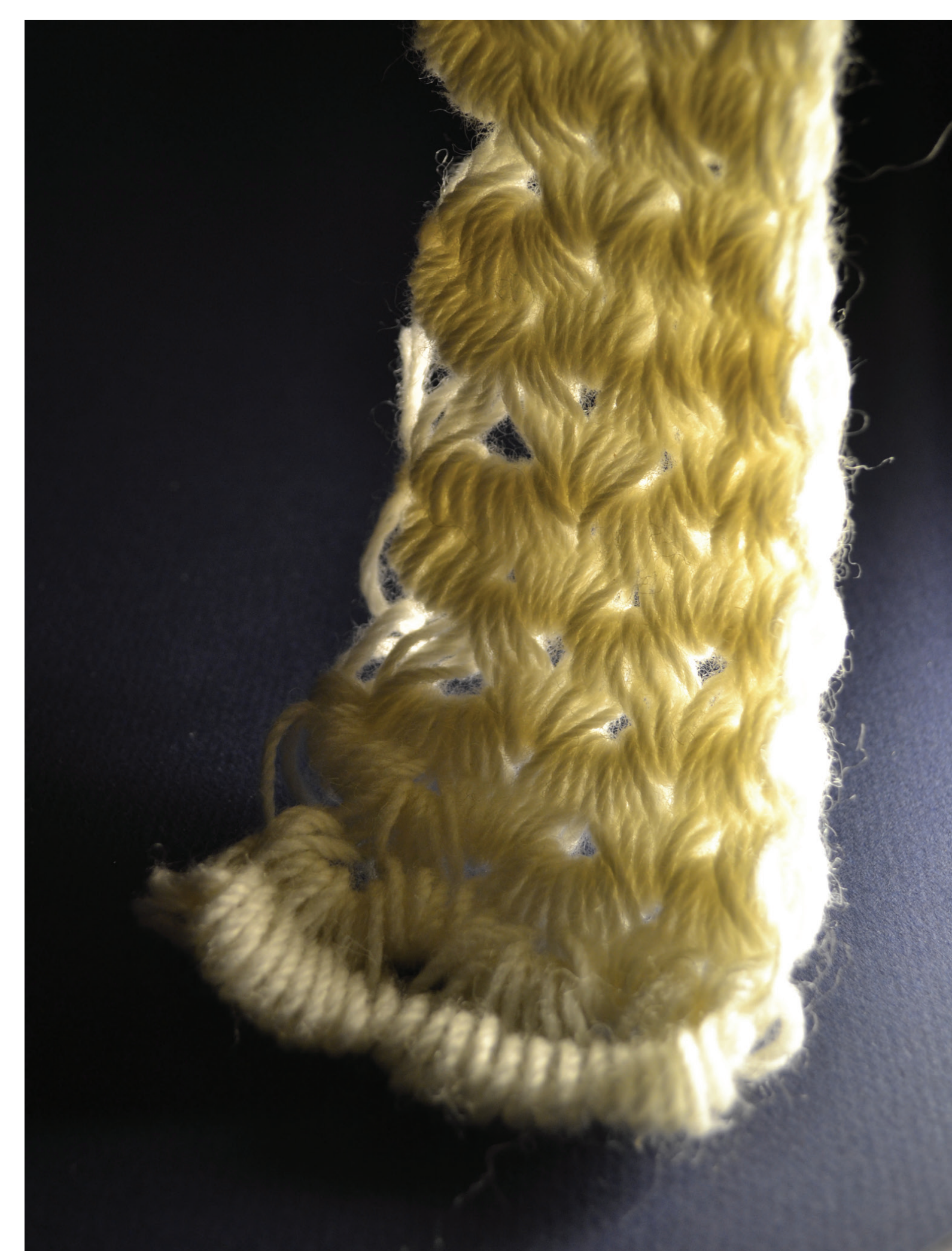
MultiWeave struktuur, pärast lõimetusse eemaldamist. The woven structure of Multiweave after removing the warp support.
