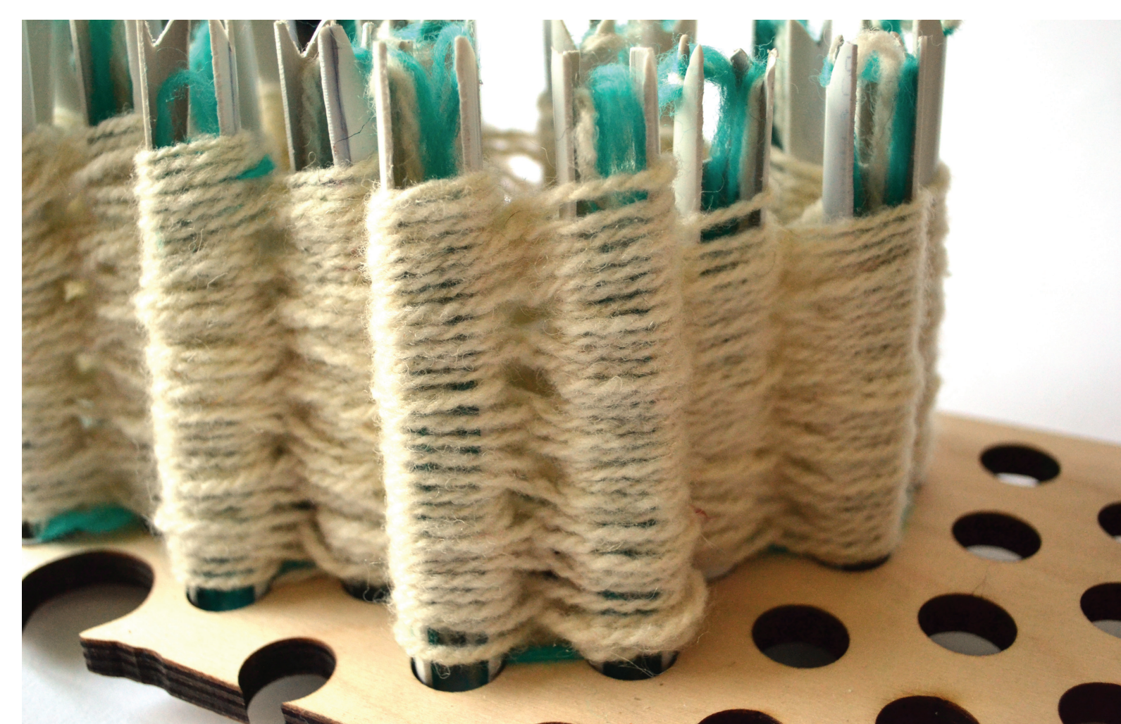
Kadi Pajupuu poolt arendatud lõimetoetussüsteem. Warp support system developed by Kadi Pajupuu
