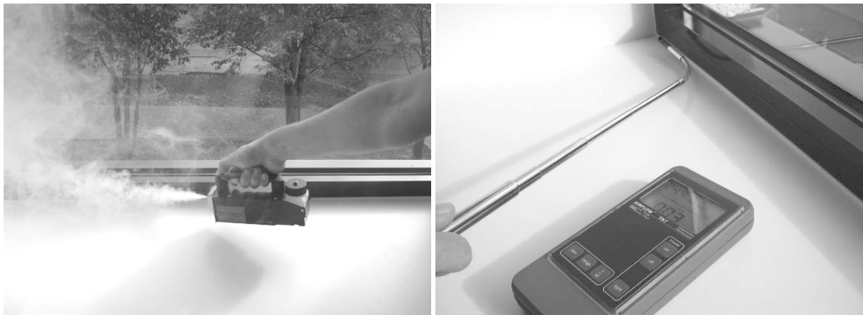
Joonis 53. Lekete avastamine ja kirjeldamine. Vasakul visualiseerimine "teatrisuitsuga" ja paremal numbriliselt anemomeetriga.
