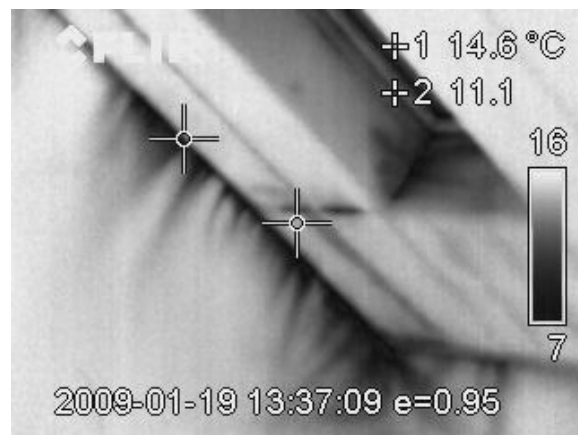
Joonis 54. Lekkekohtade visualiseerimine termokaameraga (alarõhu tingimustes, ehitusjärgus hoone). Näha katuslae ja seina ühenduskohast põhjustatud õhulekked siseruumi.
