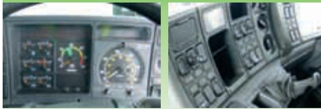
Все выключатели и рычаги работают исправно, имеются крышки для пустых гнезд.
