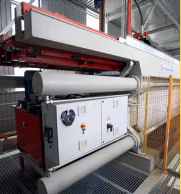
Filterpress FB/1500-120, mis võimaldas saada kokku pressitud pae-savi segu niiskussastmega 18–19%.
