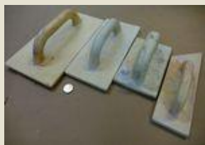
llanas de acero y talochas (madera o poliuretano)
