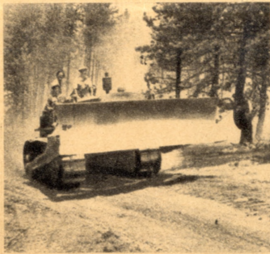
Με τὸ εἰδικὸ αὐτὸ τροχοφόρο ἐκκαθαρίζονται ὠρισμένες περιοχὲς τοῦ δάσους καὶ ἔτσι προλαμβάνεται ἡ διάδοσις τῆς φωτιᾶς καὶ πλατύτερα.
