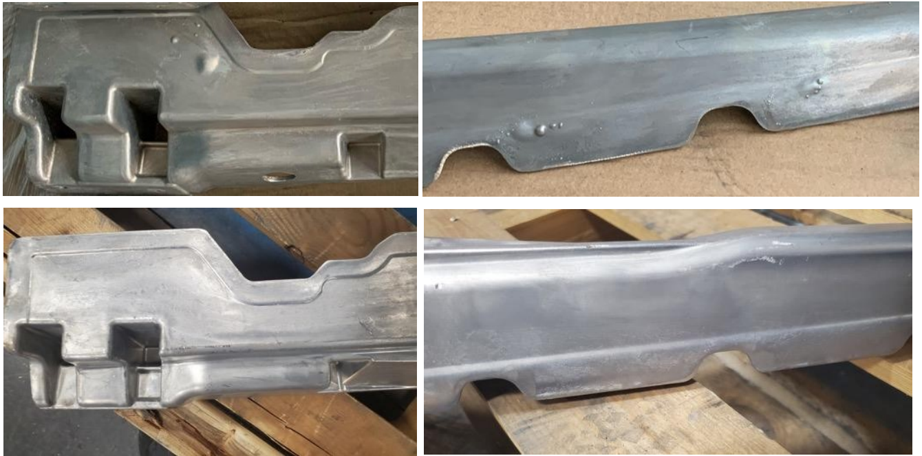
図3.固形分率が20%程度の部品（上2枚）は、通常の真空ダイカストと同様に溶体化熱処理でブリストアが発生しましたが、溶湯中の固形分率が35～45%になると解消されました（上3枚）。 鋳物のポロシティを極限まで抑えた（下2枚）
